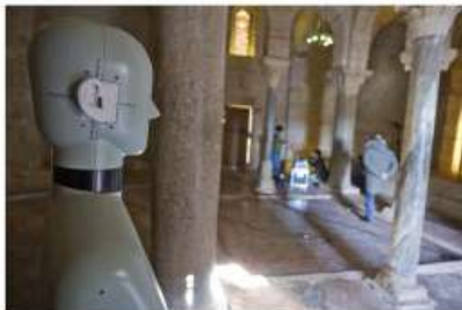
El envoltor i l'ús dels atitaveus per l'enginyers, amb un cap igual al d'una persona normal i equipat amb sensors a les diferents zones del temple a la Seu d'Ègara a la parroquia de Sant Miquel de Terrassa.
