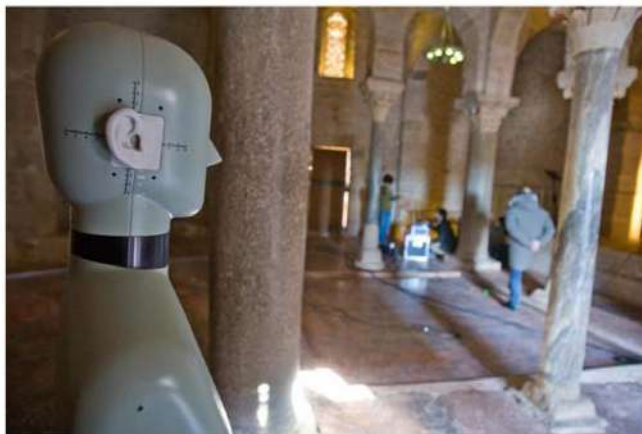
Simulador humà utilitzat pels enginyers de la UPC de Madrid a les medicions de so fetes al gener a l'església de Sant Miquel / Nebridi Aróztégui
